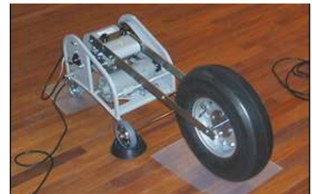
マンション等の住宅性能試験 重量床衝撃音測定用のバンクマシン
